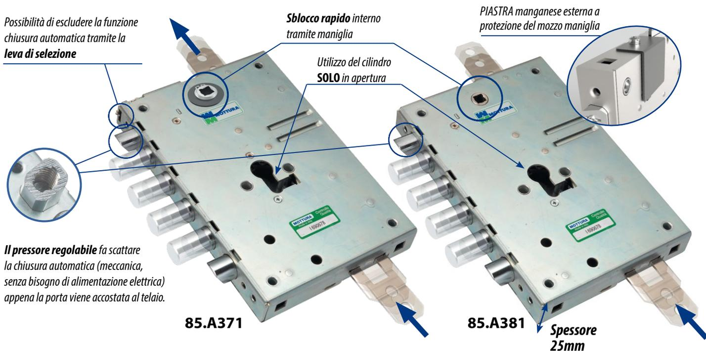
**Lo spessore ridotto di 25 mm** (30 mm solo su mozzo maniglia per versioni 85A371/571) permette di inserire la piastra di protezione al manganese con Defender Ø 50 TOP SYSTEM, per aumentare al massimo livello la resistenza ai tentativi di effrazione e scasso. Rende possibile inoltre l'inserimento di pannelli ignifughi, fonoassorbenti o termoisolanti.
